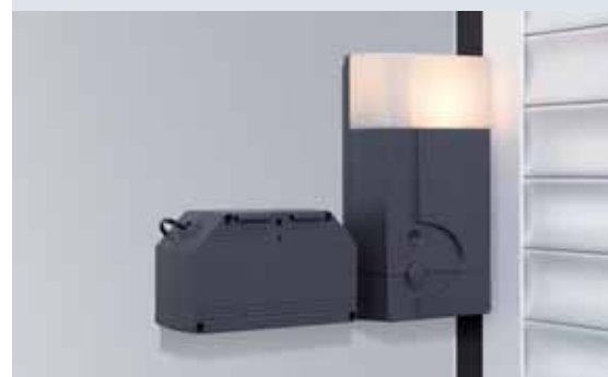
Nødbatteriet Med denne nødforsyning kan du overvinde netspændingssvigt i op til 18 timer og maks. 5 portcyklusser. Ved normal drift genoplader nødbatteriet sig selv.
